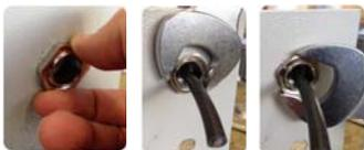
5) Die Druckmutter kann von Hand mit Daumen und Zeigefinger (beidhändig) bis in den vorgegebenen Bereich vom Gap angezogen werden.
