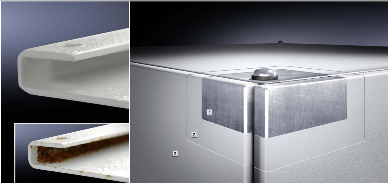
열반 시스템 TS 8의 3중 표면 처리는 최적의 부식 방지 효과를 제공하며, 또한 예를 들어 세척 시 사용하는 광유, 윤활제, 가공 유제와 용제에 대한 저항성이 있습니다. 리탈은 자동차 산업 분야의 도장과 상응하는 품질을 표준형으로 제공하는 유일한 인클로저 제조업체입니다. 이러한 품질은 지속적인 공정 모니터링을 통해 보장됩니다.
