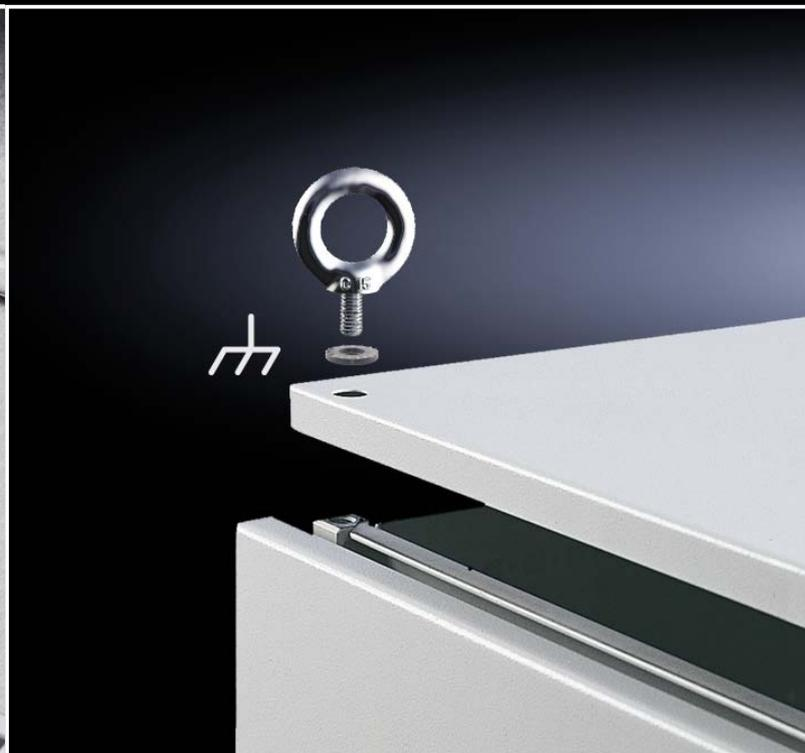
글랜드 플레이트, 측면 패널, 후면 패널 및 루프에서 등전위화가 조립과 동시에 자동으로 이루어집니다. 이는 모든 패널 구성품이 프레임에 전도성으로 연결되어 있음을 보장합니다. 전기 장치가 장착되지 않은 패널 부품에는 접지 스트랩을 생략할 수 있습니다.
