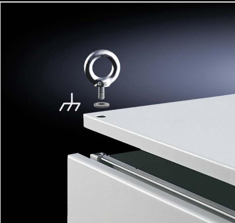
Vyrovnaní potenciálu podlahových plechů, bočních a zadních panelů a střechy je zajištěno automaticky při montáži skříně díky vodivému spojení rámu se všemi plochými částmi. Když na bočních panelech nejsou instalovány žádné elektrické komponenty, není nutné k pospojování použít zemnicí pásky.
