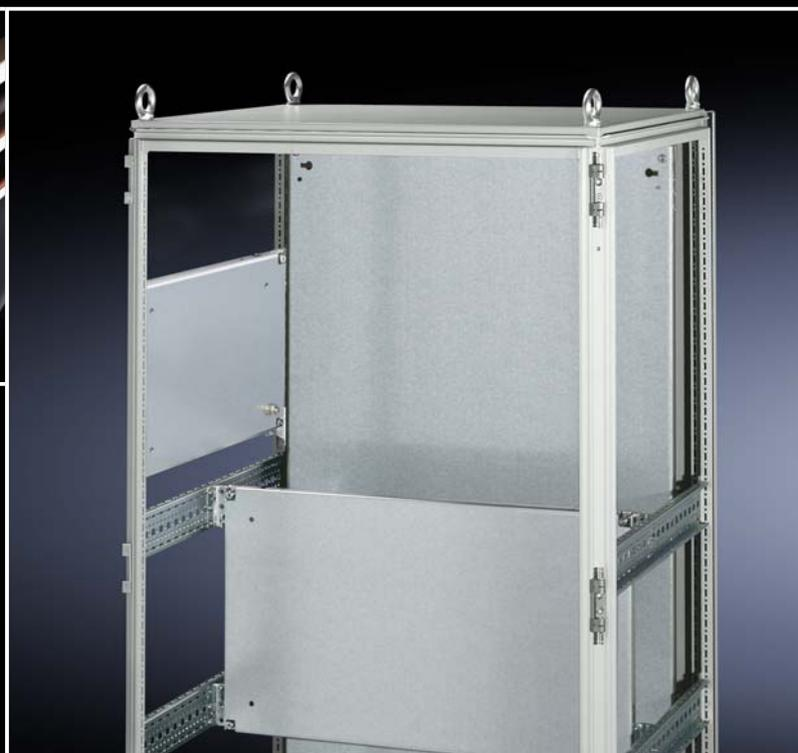
La struttura su due piani di montaggio è realizzata con montanti verticali in profilato di lamiera di acciaio ripiegato 16 volte. Il sistema a due livelli rende disponibile, già negli armadi di serie, un secondo piano di montaggio, ovvero fino al 15% di spazio utile in più nell'armadio!
