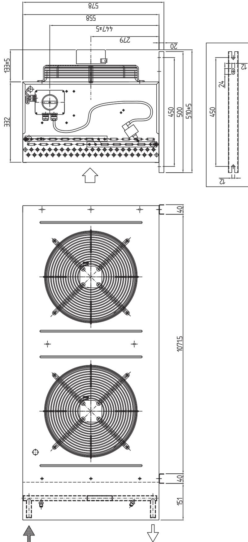
Abb. 72: Standard-Verflüssiger 3311.360 (Fassadenmontage)
