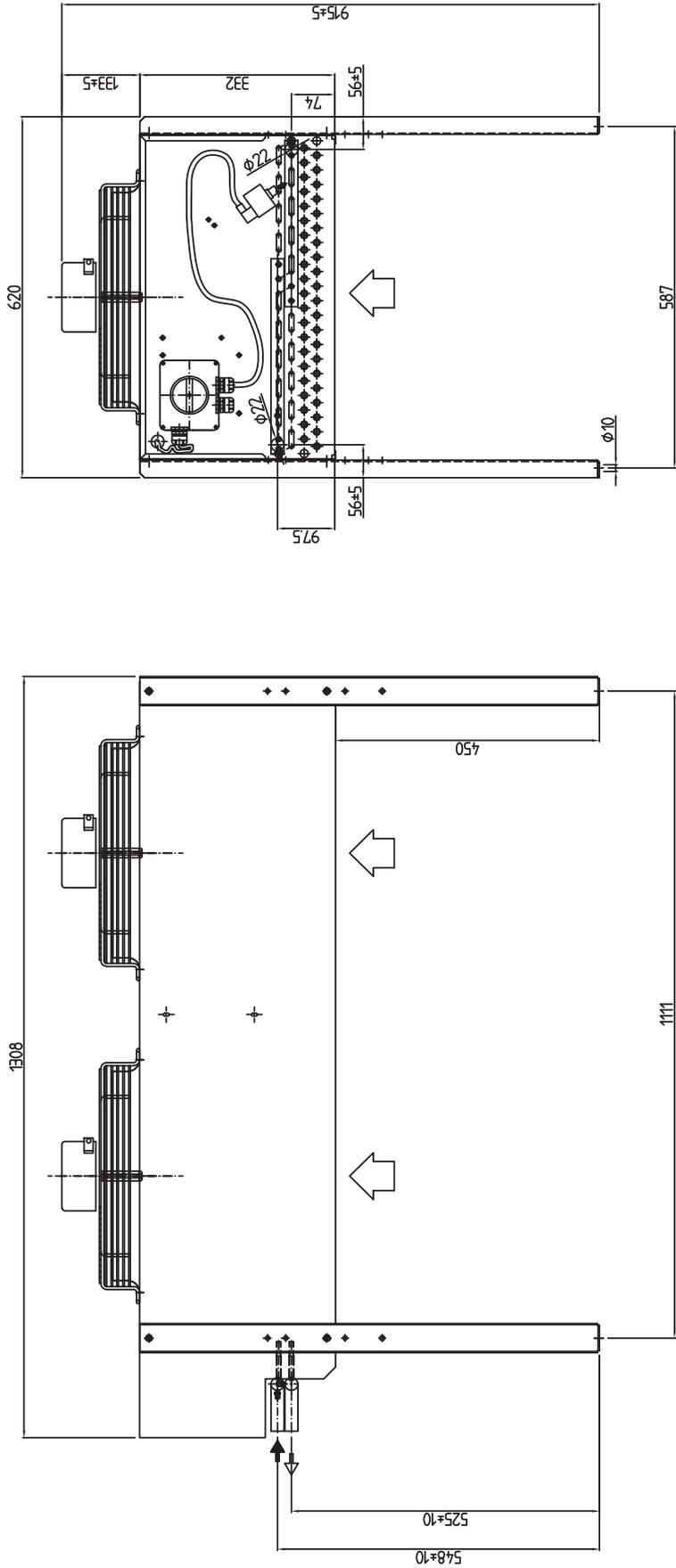
Abb. 71: Standard-Verflüssiger 3311.360 (Pultmontage)
