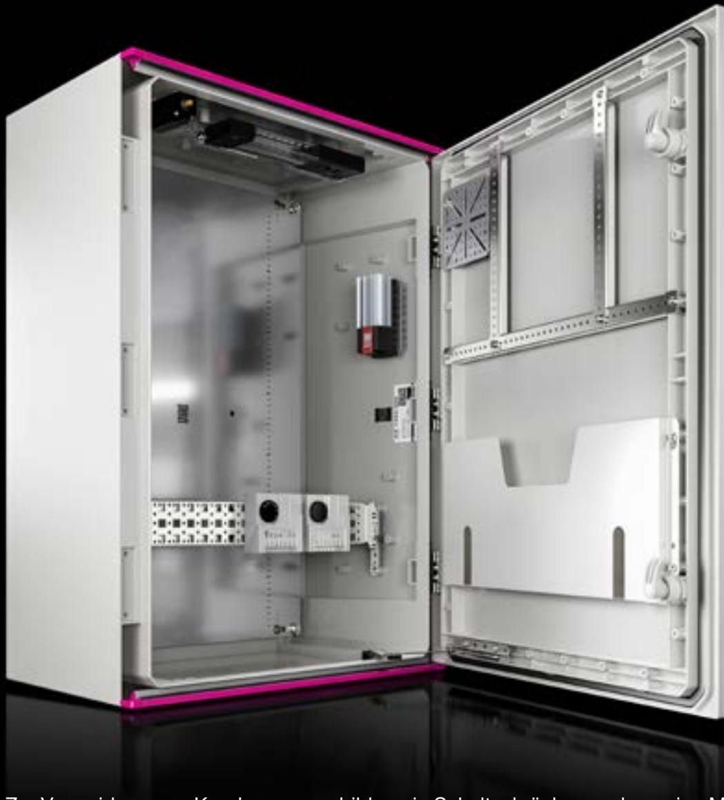
Zur Vermeidung von Kondenswasserbildung in Schaltschränken und um eine Mindestbetriebs-temperatur zu erreichen (z. B. bei Abschaltung der Anlage über Nacht), werden Schaltschrank-Heizungen eingesetzt.
