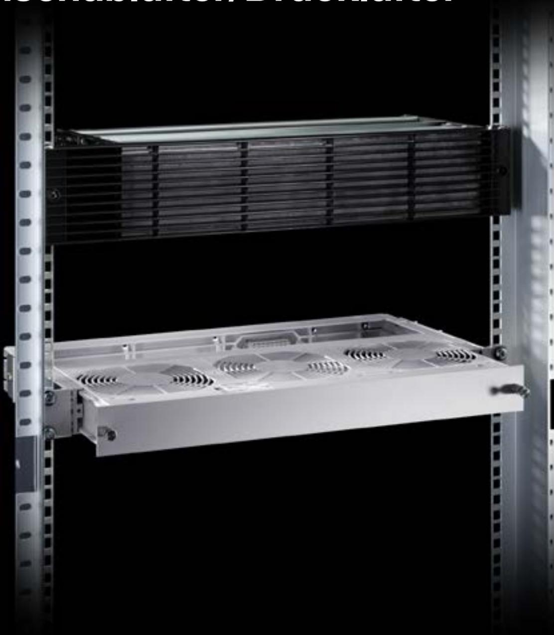
Alle Einschub-Klimatisierungskomponenten werden direkt an der zölligen Befestigungsebene für Baugruppenträger montiert. Durch ihre Positionierung direkt unter den Elektronikkomponenten ist eine effektive Kühlung gesichert und die Bildung von Wärmenestern wird vermieden.
