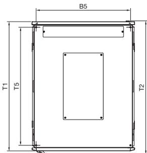
Draufsicht, Breite 600 mm, mit Seitenwänden
