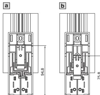
Befestigungsmöglichkeiten auf Tragschiene
