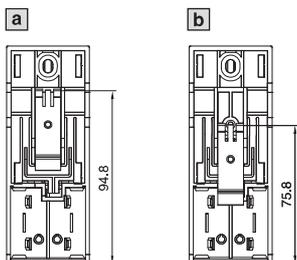
Befestigungsmöglichkeiten auf Tragschiene
