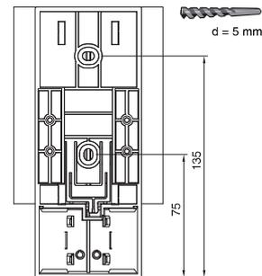
Befestigungsmöglichkeiten auf Tragschiene
