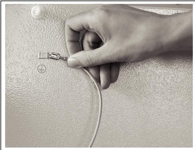
Abb. 26: Erdungskabel abziehen
