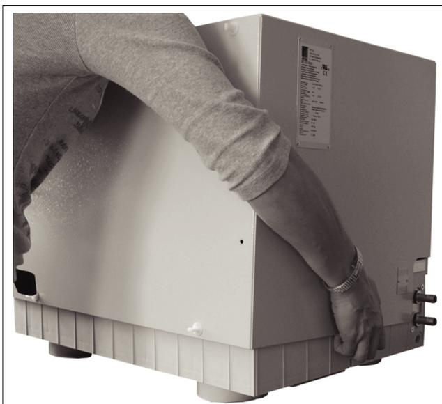
Fig. 28 : Déposer le capot
