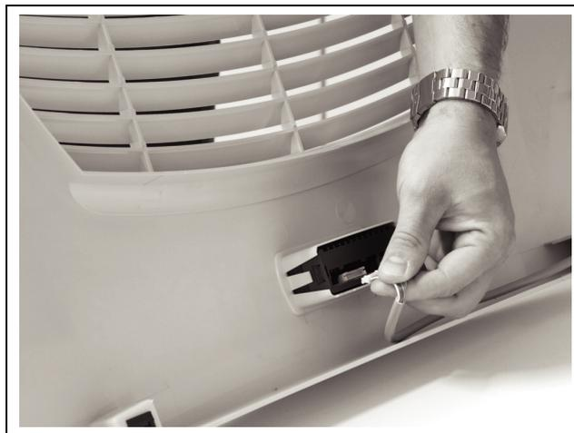
Fig. 25 : Ôter le connecteur de l'afficheur
