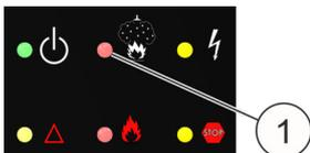
Fig. 21 : LED « Installation d'extinction commandée »
