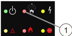
Fig. 23 : LED « Installation d'extinction commandée »
