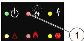
Fig. 21: LED “Instalación de extinción activada”
