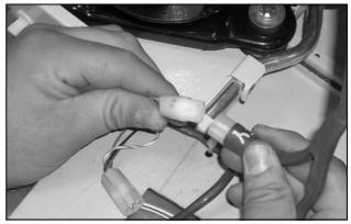
Fig. 43: Disconnect the fan connectors
