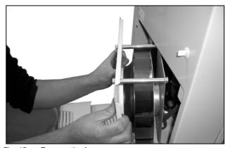
Fig. 42: Remove the fan
