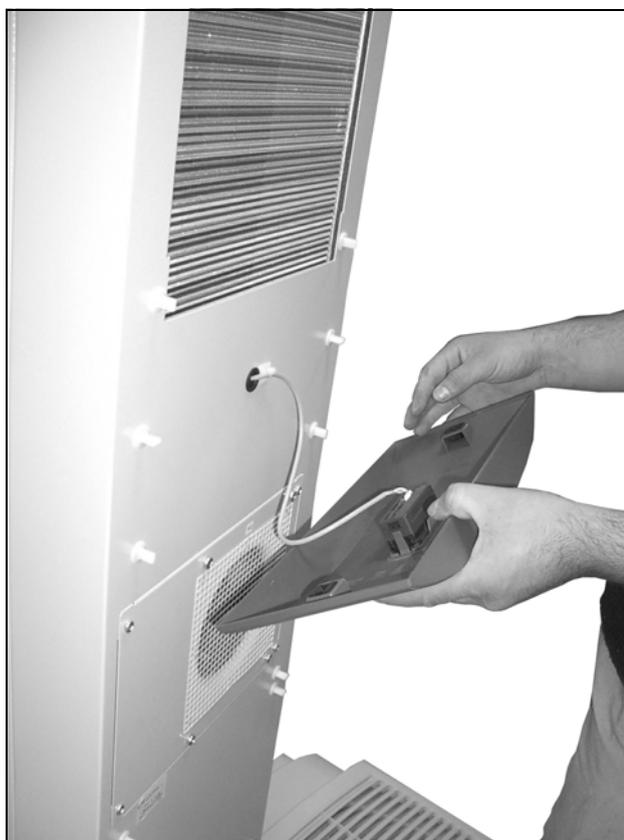
Fig. 59 : Retirer le plastron
