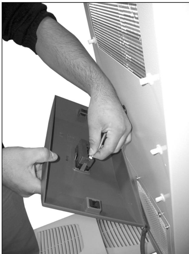
Fig. 38 : Ôter le connecteur de l'afficheur (1)
