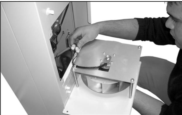
Fig. 65 : Débrancher les fiches de raccordement du ventilateur (1)
