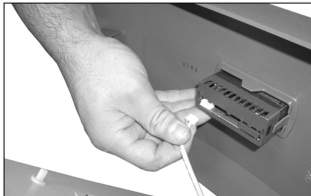
Fig. 60 : Débrancher le câble de l'afficheur
