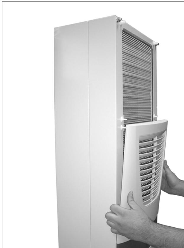
Fig. 56 : Retirer la grille à lamelles supérieure (3)
