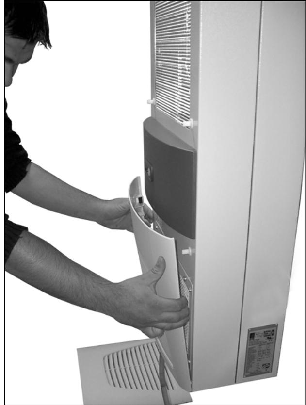
Fig. 36 : Retirer la grille à lamelles inférieure
