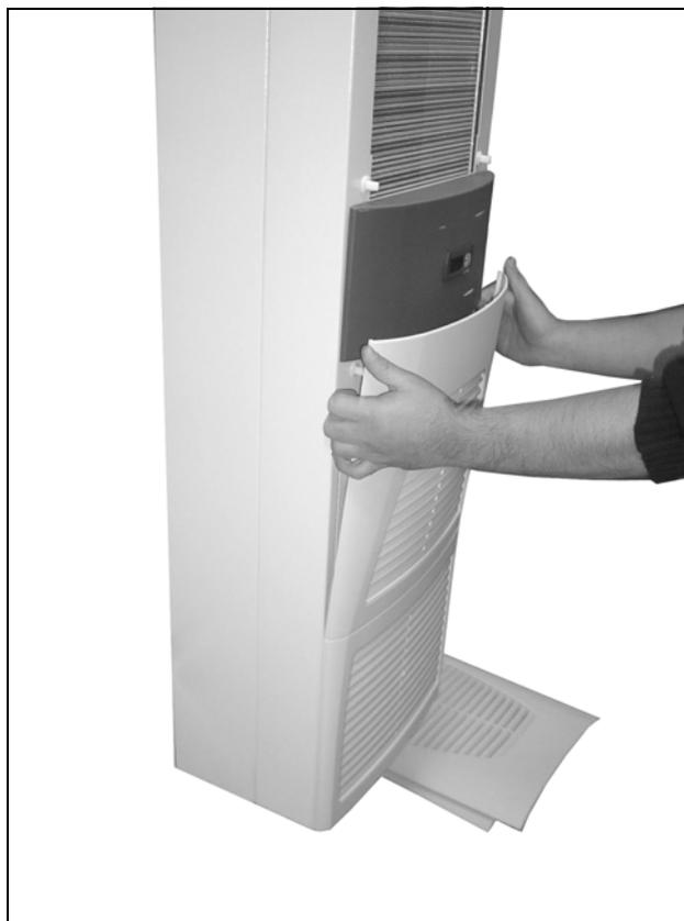
Fig. 57 : Retirer la grille à lamelles inférieure (1)
