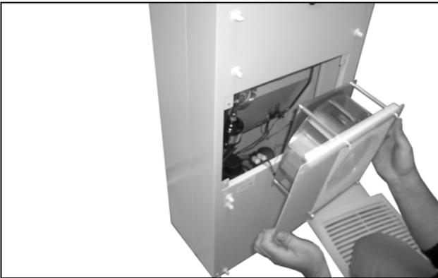
Fig. 64 : Démonter le ventilateur du circuit externe
