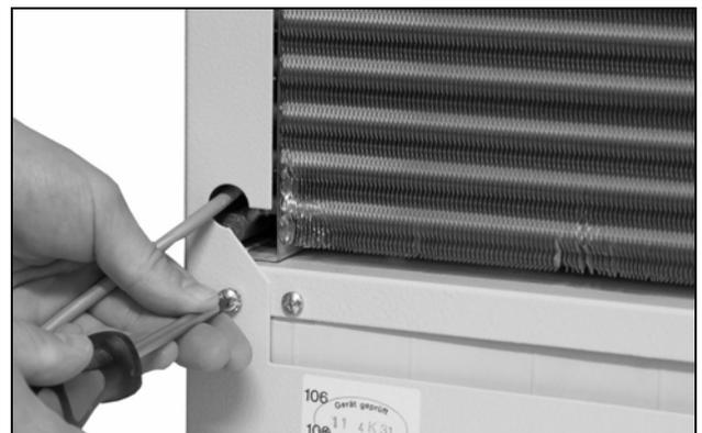
Fig. 26 : Dévisser les vis de fixation du capot (quatre vis)
