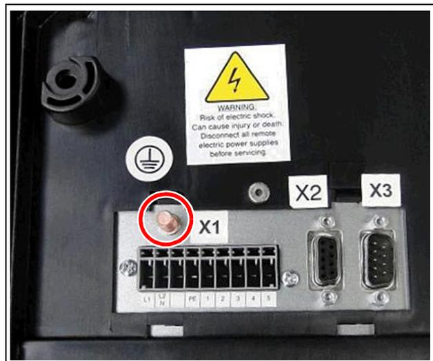
Fig. 11 : Plot de mise à la masse
