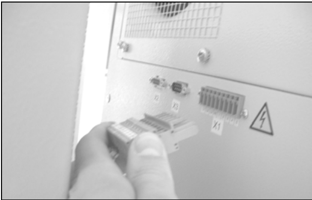
Obr. 34: Vytiahnutie sieťovej zástrčky
