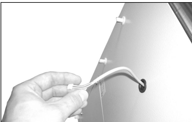
Obr. 45: Prestrčenie kábla displeja
