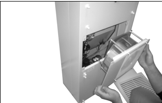
Obr. 64: Demontáž ventilátora vonkajšieho okruhu
