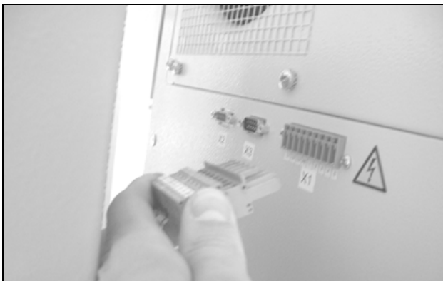
Obr. 53: Vytiahnutie sieťovej zástrčky
