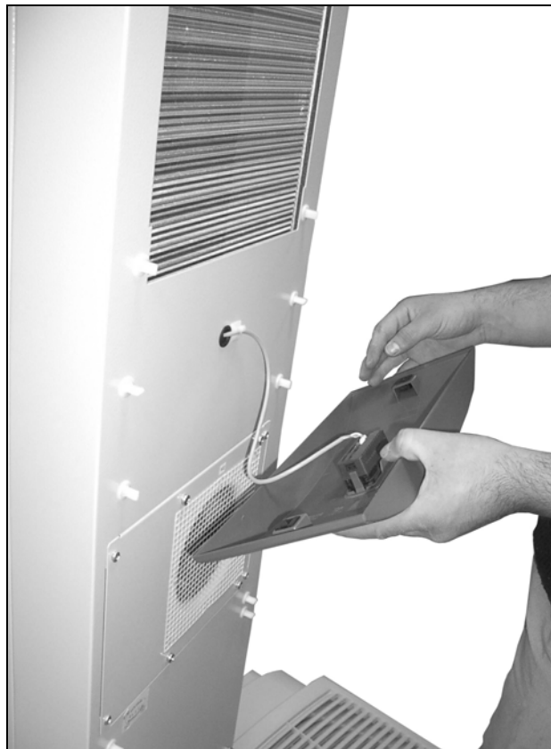
Obr. 59: Demontáž čelného modulu
