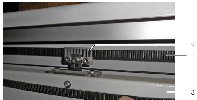
Рис. 36: Крепление зубчатого ремня на левой двери
