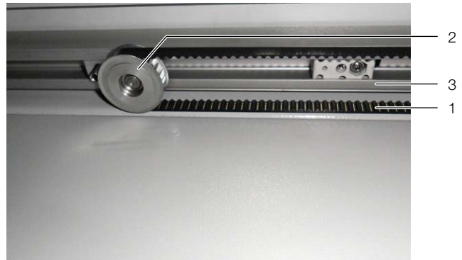
Рис. 35: Зубчатый ремень на зубчатом колесе
