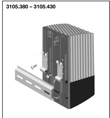
Рис. 2: Защелкивающееся крепление на 35 мм несущей шине DIN EN 50 022
