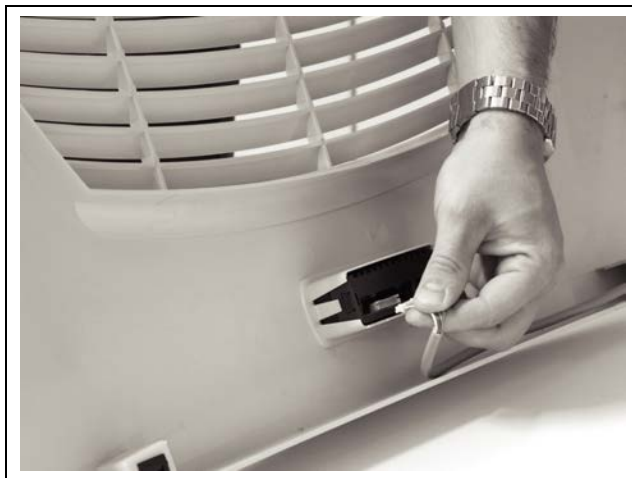
Obr. 25: Odpojte konektor od displeje
