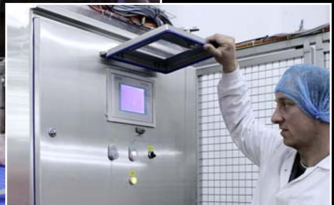
La ventana transparente abatible ofrece durante la limpieza una protección adicional de la pantalla instalada en el armario HD.
