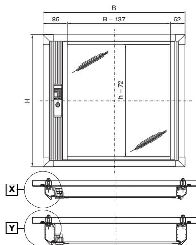
Sichtfläche (B - 137) um 16,5 mm zur Scharnierseite versetzt
