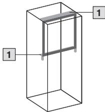
1 Einbausatz für Schwenkrahmen, klein
