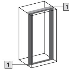
Der seitliche Einbau eines Schwenkrahmens, groß, ist bei einer Schranktiefe von 800 mm identisch mit dem Einbau parallel zur Front. Für den Zugang zum Schwenkrahmen empfehlen wir die Scharniere für die Seitenwand.
