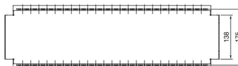
Plaques de socle avec brosse passe-câbles, hauteur 100 mm, vue de face
