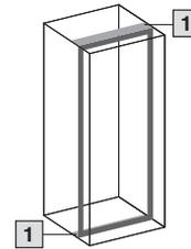
El montaje lateral de un bastidor móvil, grande, en una profundidad de armario de 600 mm, es idéntico al montaje en paralelo al frontal. Para el acceso al bastidor móvil recomendamos las bisagras para el lateral.
