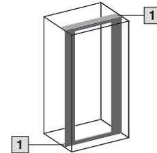
El montaje lateral de un bastidor móvil, grande, en una profundidad de armario de 600 o 800 mm, es idéntico al montaje en paralelo al frontal. Para el acceso al bastidor móvil recomendamos las bisagras para el lateral.
