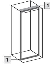
A montagem lateral de um quadro com dobradiça grande em um armário com 600 mm de profundidade é idêntica à montagem paralela com a frente. Para garantir o acesso ao quadro montado com dobradiça, recomendamos a dobradiça para a lateral.
