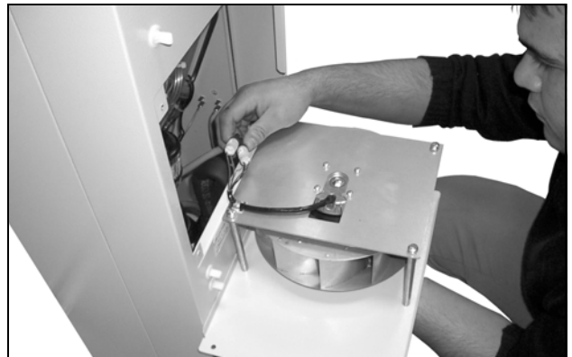
Bild 65: Dra ut fläktens kontaktdon (1)
