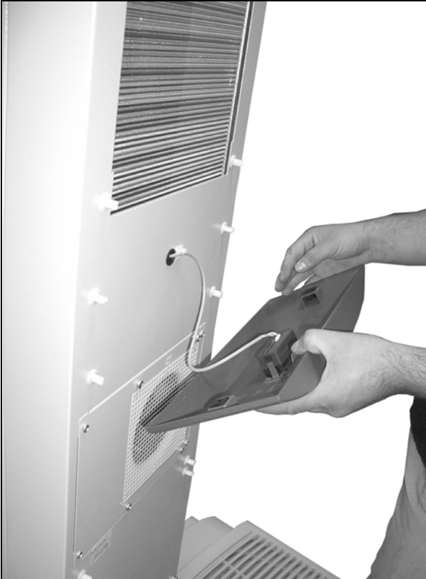
Bild 59: Ta bort mittbandet
