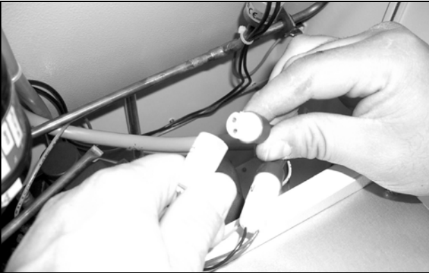
Bild 67: Dra ut fläktens kontaktdon (3)
