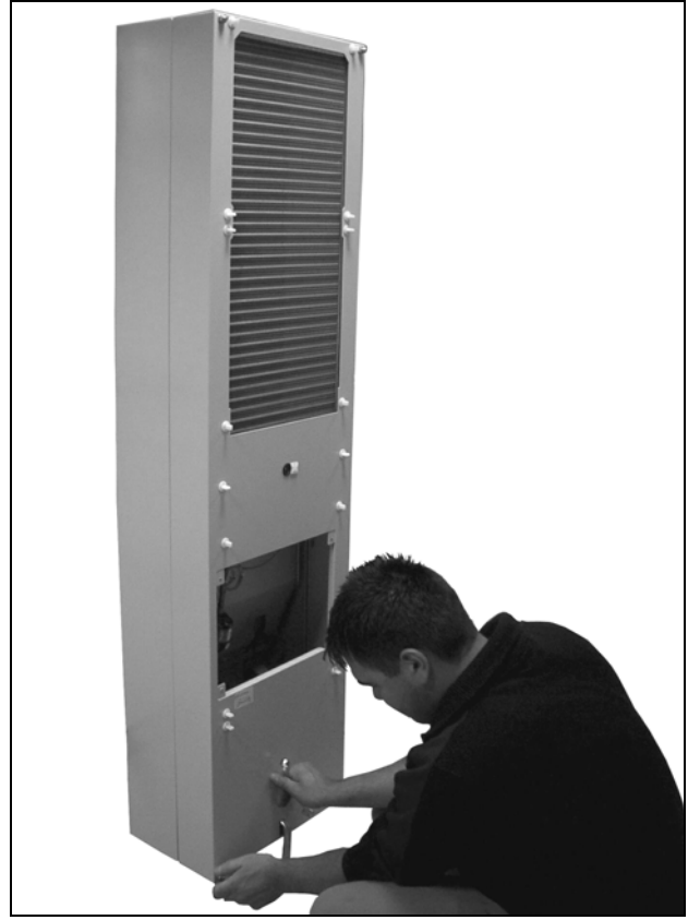
Bild 70: Lossa fyra muttrar på höljet
