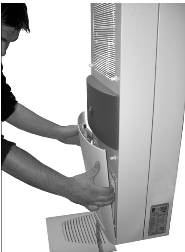
Bild 36: Ta bort det nedre lamellgallret
