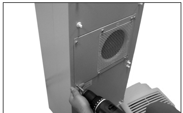
Rys. 63: Luzowanie czterech śrub wentylatora obiegu zewnętrznego
