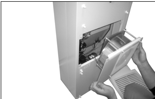
Rys. 64: Demontaż wentylatora obiegu zewnętrznego
