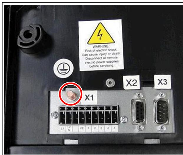
Imagen 11: Punto de conexión, compensación de potencial
