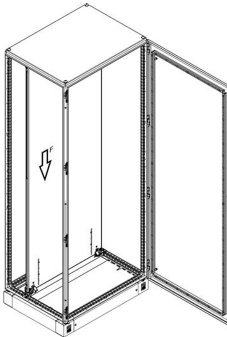
Position de montage en retrait de 20 mm par rapport à l'ossature d'armoire (**VX25**)
