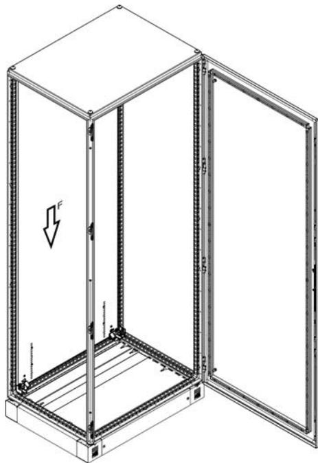
Position de montage avancée par rapport à l'ossature d'armoire (**VX25, VX SE**)  $F = 5000 \text{ N}$
