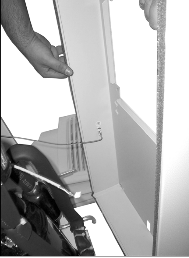
Şek. 72: Topraklama kablosunu çıkarın (1)
