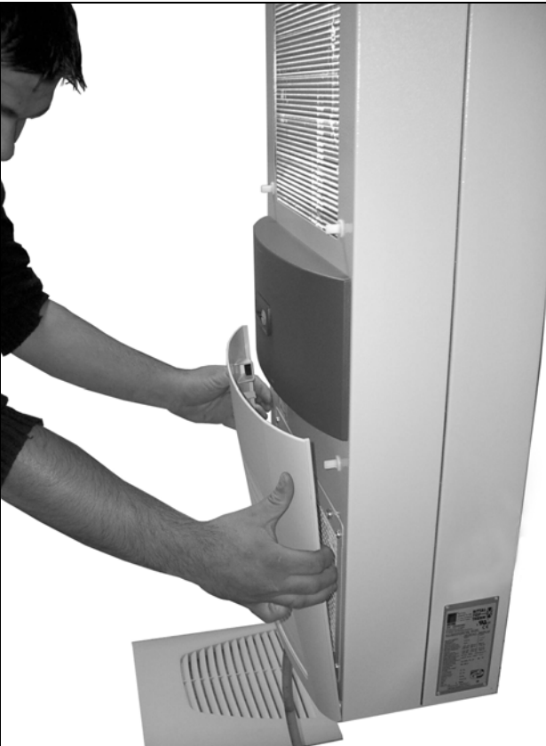
Şek. 36: Alt lamel ızgarasını çıkarın
