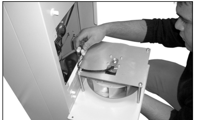
Şek. 65: Fanın konektör bağlantısını çıkarın (1)
