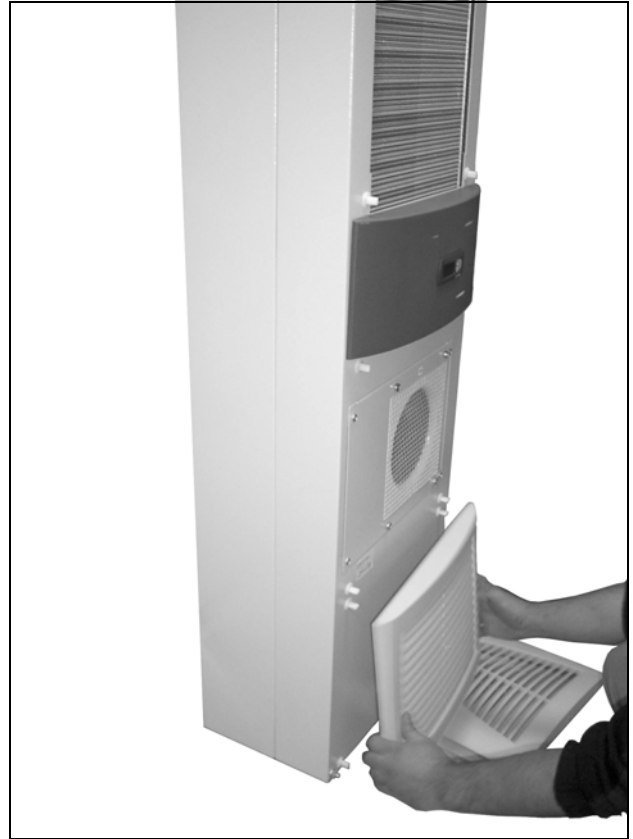
Şek. 58: Alt lamel ızgarasını çıkarın (2)
