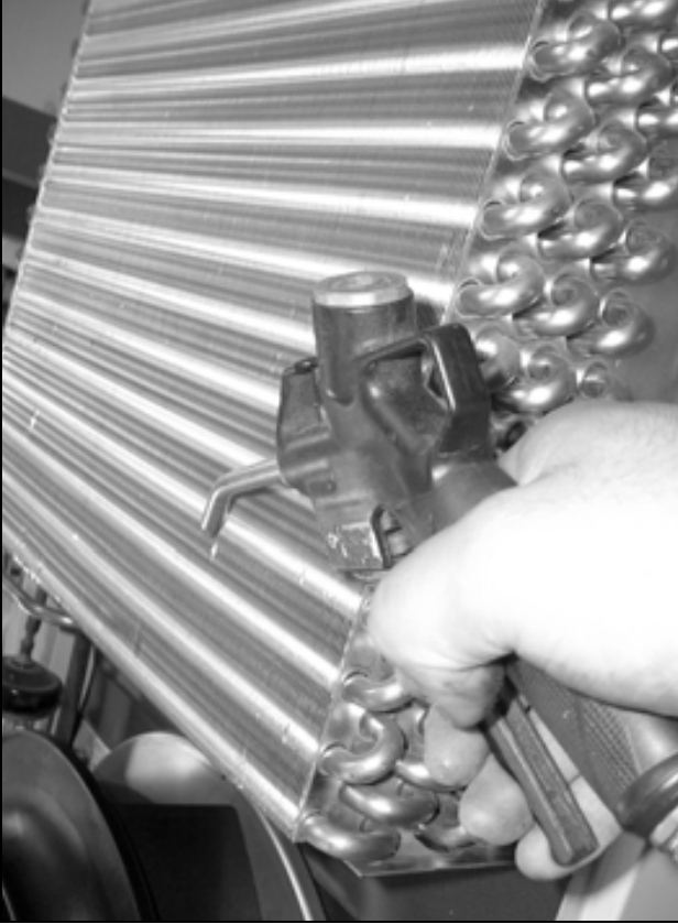
Şek. 51: Isı eşanjörü devresi ve kompresör odasını basınçlı hava ile temizleyin (1)
