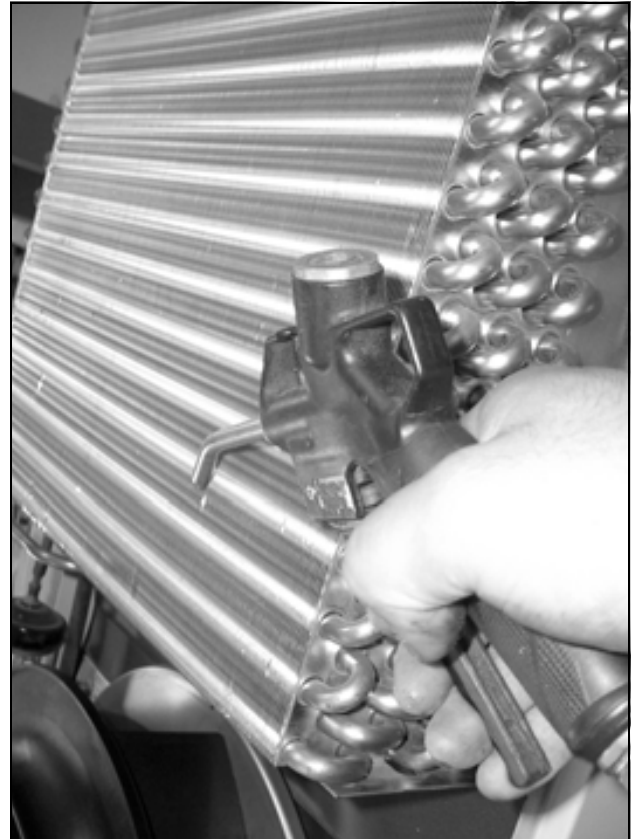
Şek. 75: Isı eşanjörü devresi ve kompresör odasını basınçlı hava ile temizleyin (2)
