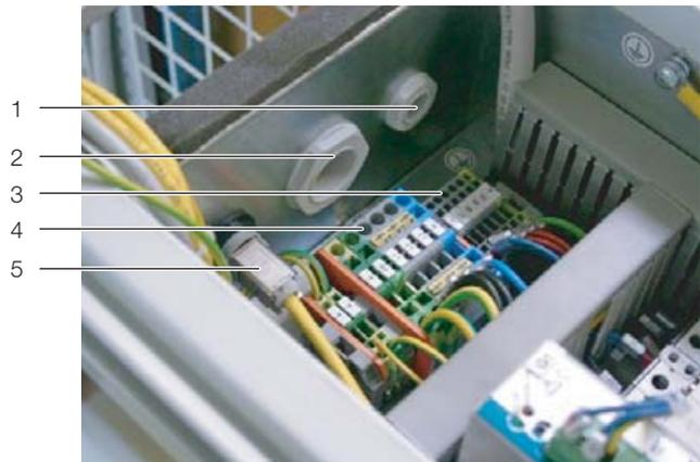
Imagen 29: Bornes de conexión en la caja de electrónica
