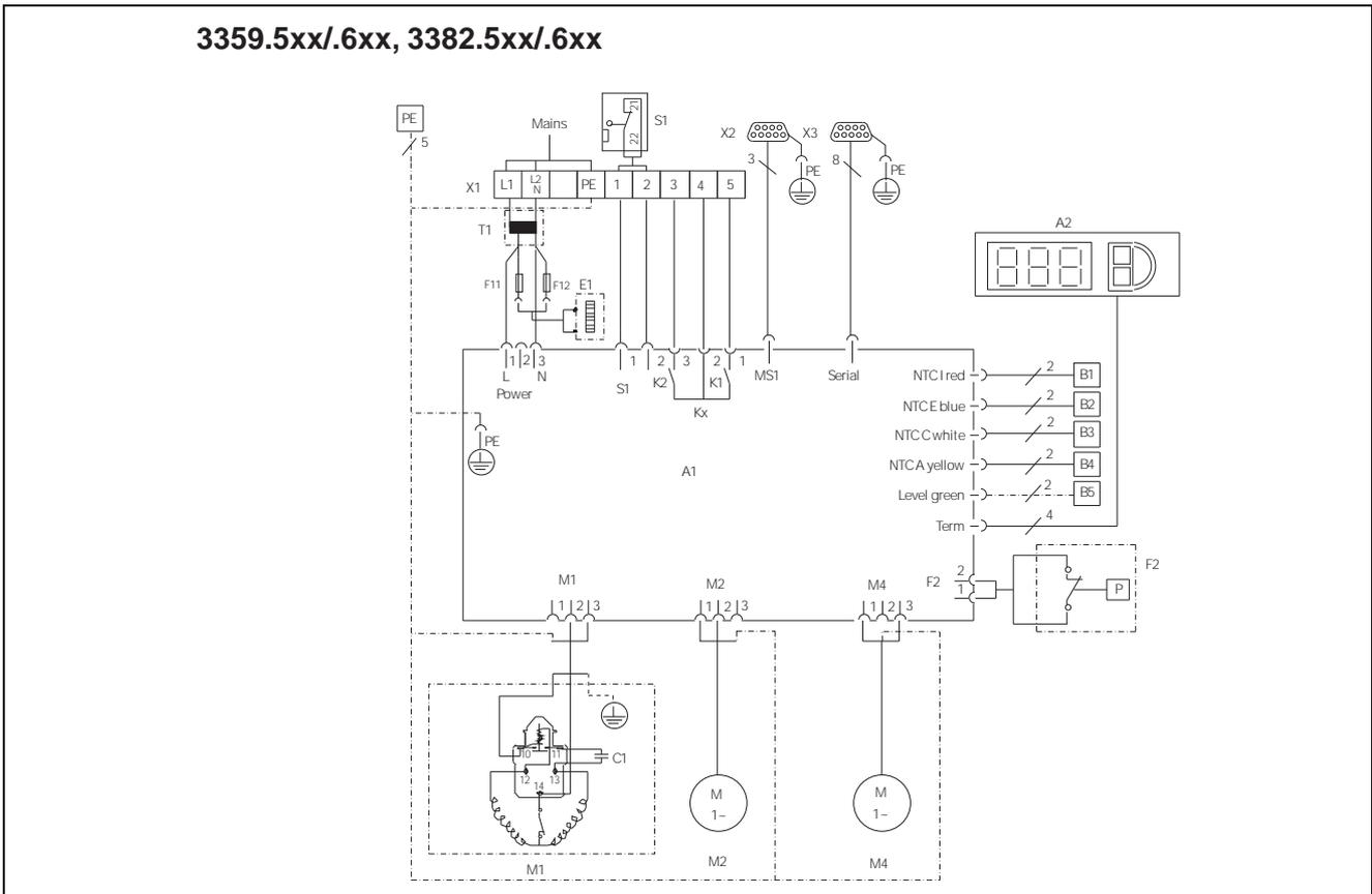
Fig. 39: Esquema de conexões elétricas nº 1
