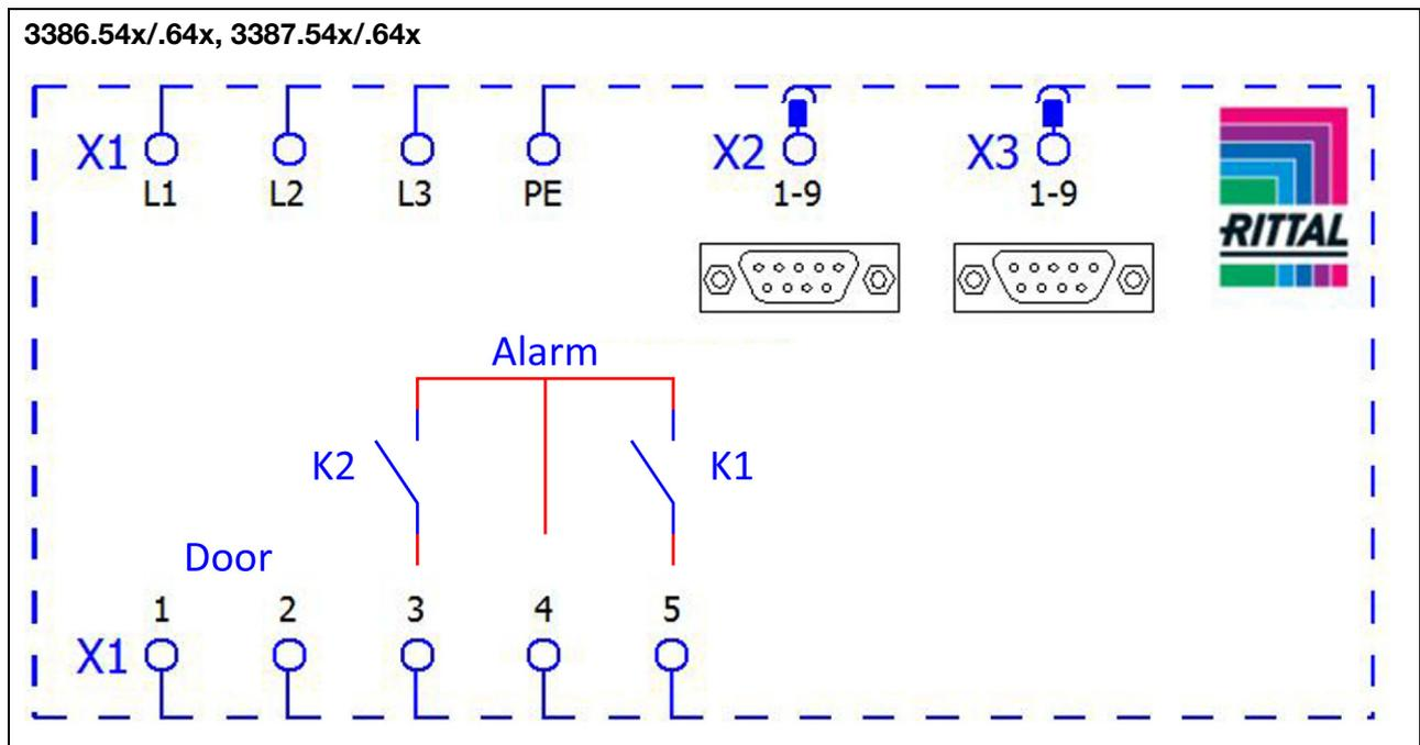
Fig. 15: Esquema de conexões elétricas nº 3
