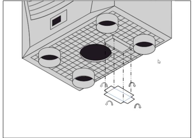
Abb. 6.1: Placa de vedação ao redor da carcaça do evaporador de condensado da unidade de resfriamento
