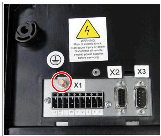
Fig. 11: Ponto de conexão, potencial de equalização
