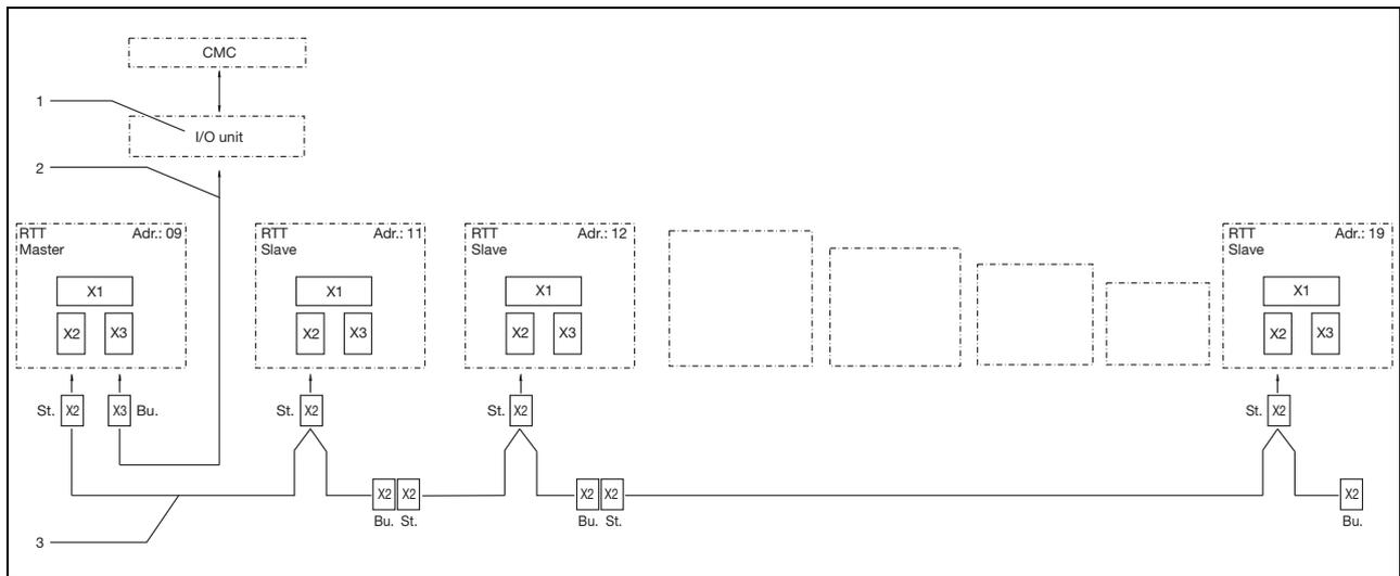
Fig. 12: Exemplo de conexão: configuração mestre-escravo
