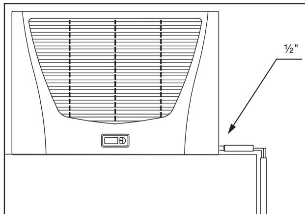
Fig. 10: Instalação da saída para a água condensada
