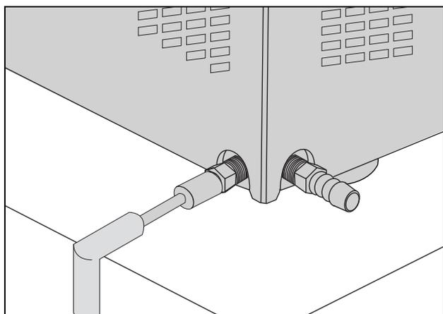
Fig. 9: Conexão da saída para a água condensada
