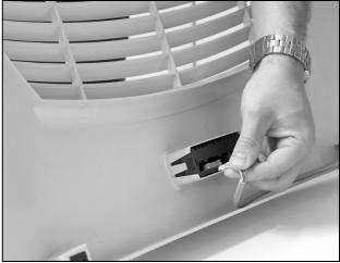
Fig. 24: Desencaixar o conector do display
