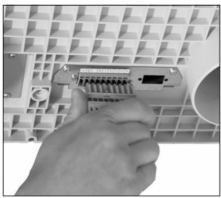
Fig. 21: Desconectar a alimentação de tensão
