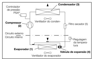
Fig. 2: Circuito de refrigeração
