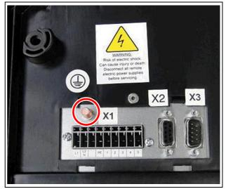
Fig. 11: Ponto de conexão, potêncial de equalização
