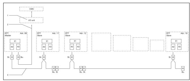
Fig. 12: Exemplo de conexão: configuração mestre-escravo
