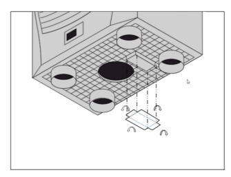
Abb. 6.1: Placa de vedação ao redor da carcaça do evaporador de condensado da unidade de resfriamento
