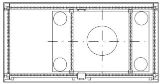
Fig. 8: Reforço da chapa de teto de um armário
