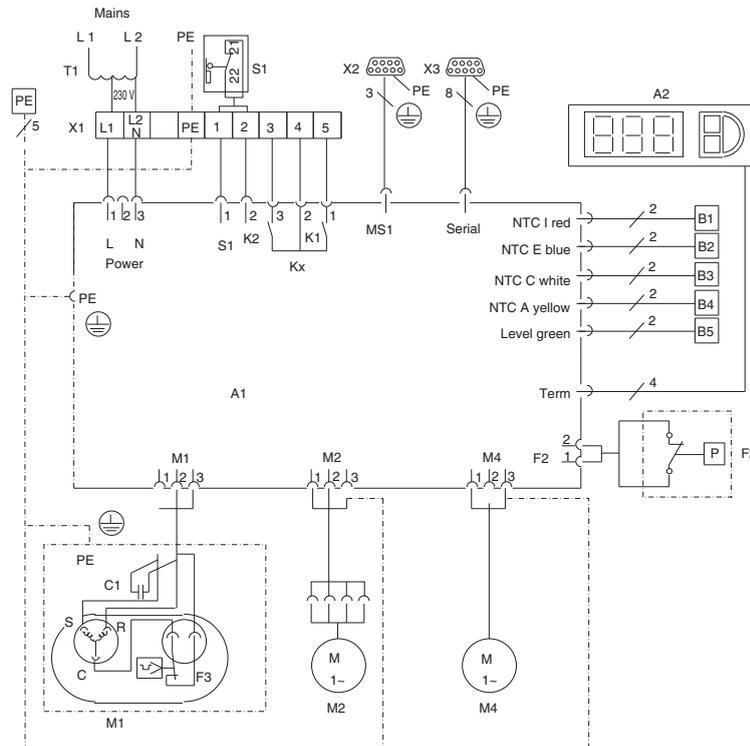
Imagen 113: Esquema de conexiones electrónicas nº 3
