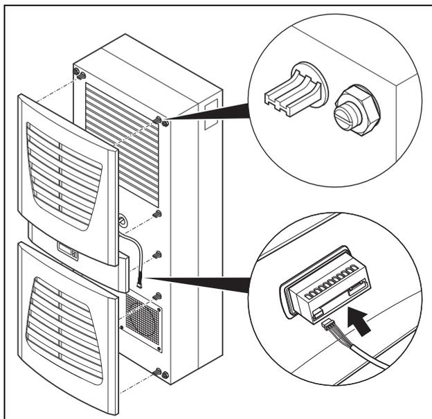
Imagen 27: Conectar el display y colocar la rejilla
