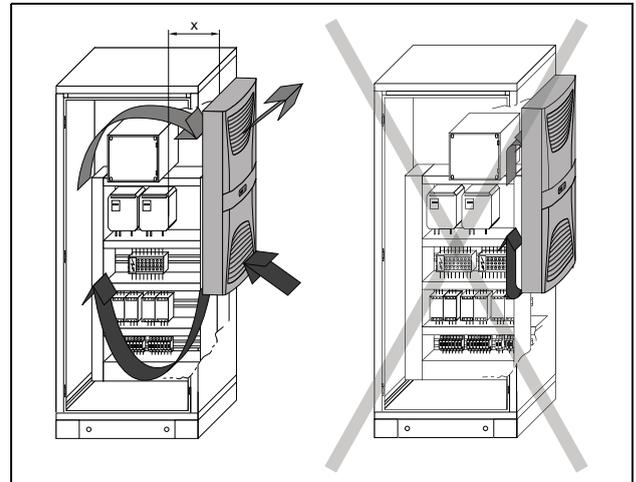
Imagen 5: Circulación del aire en el armario
