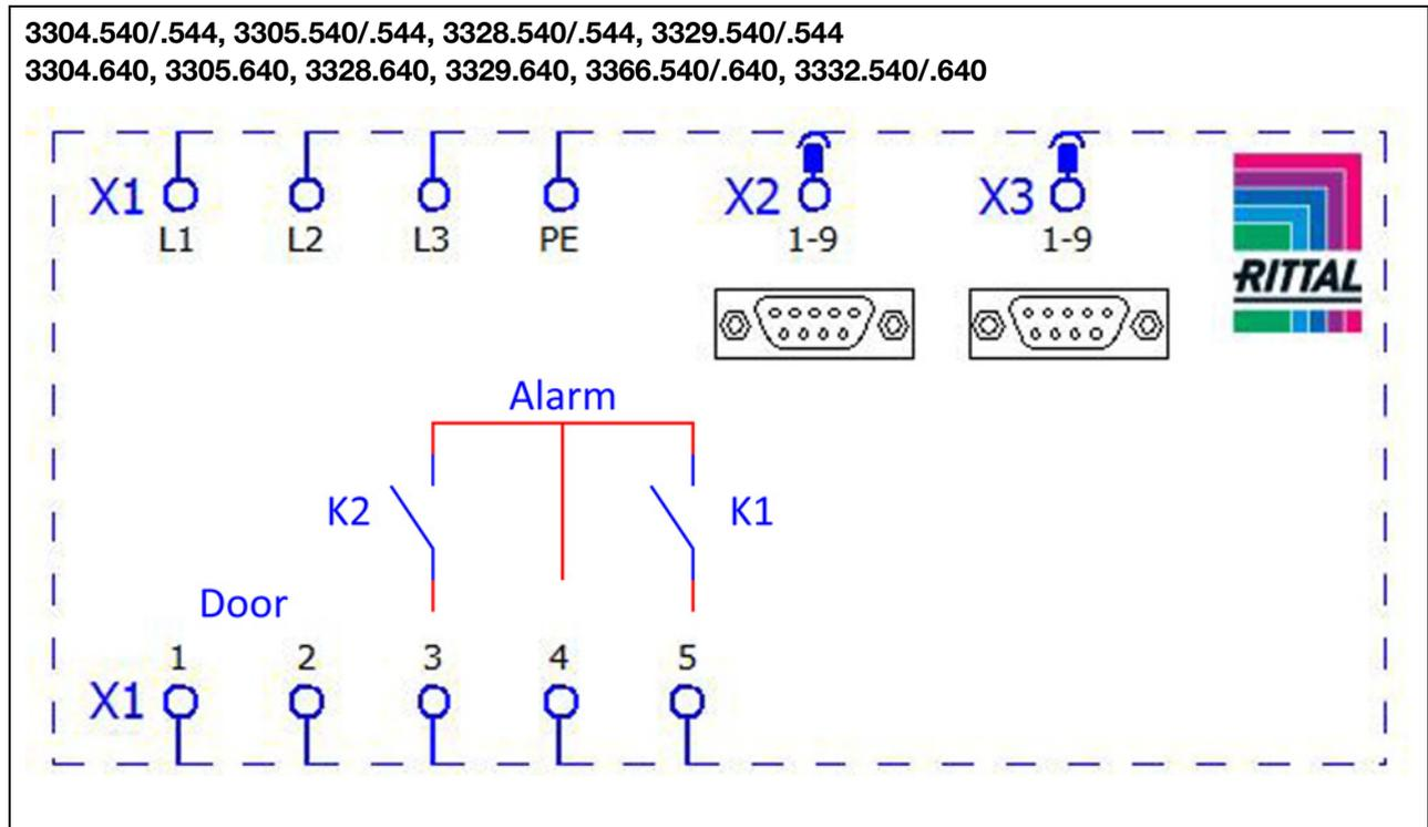
Imagen 25: Esquema de conexiones electrónicas n° 3
