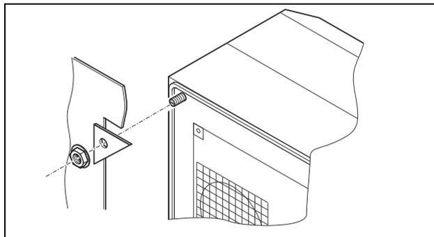
Imagen 9: Fijar el refrigerador (sólo 3302.1xx «montaje exterior»)
