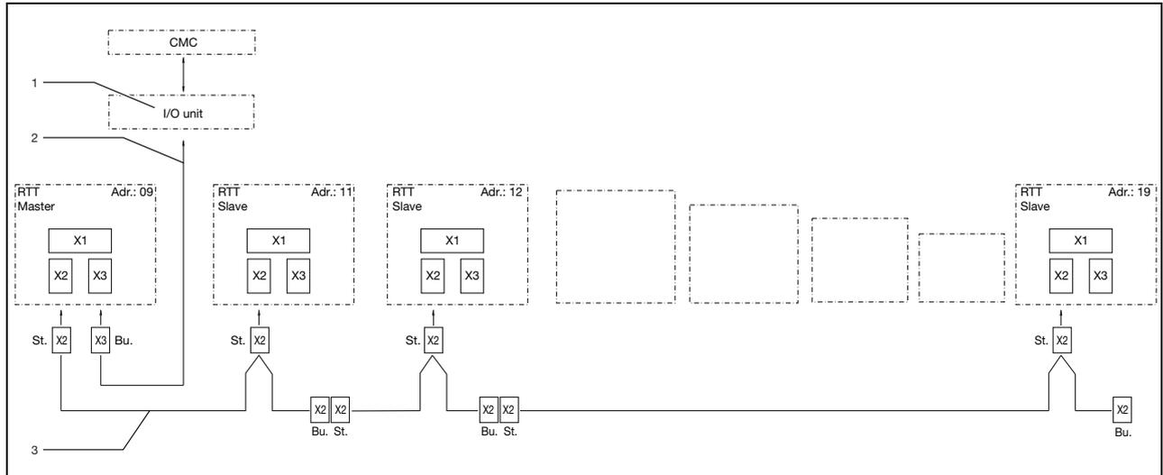
Imagen 21: Ejemplo de conexión: Funcionamiento maestro-esclavo
