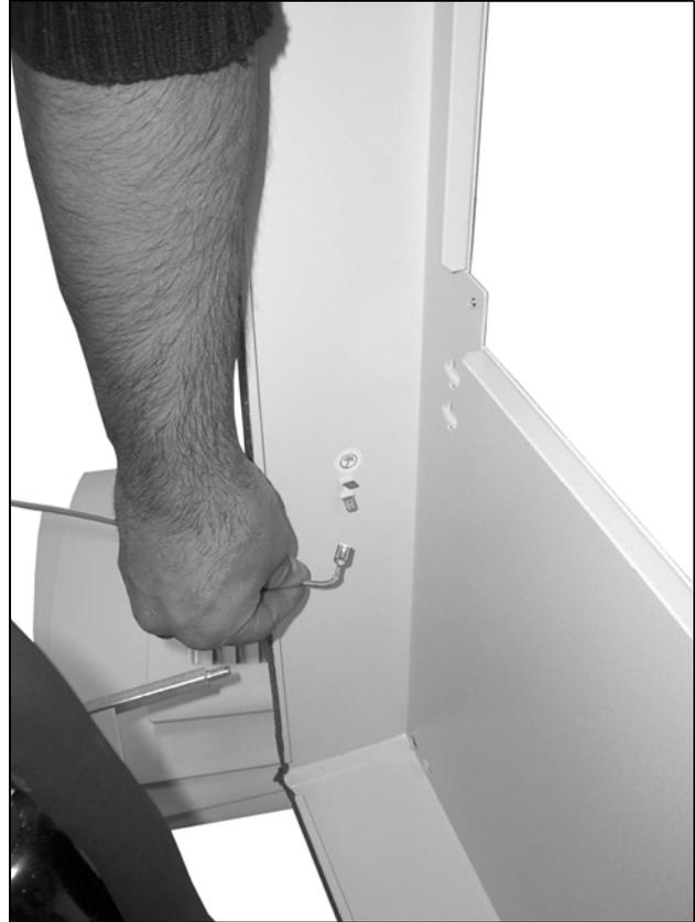
Imagen 73: Desconectar el cable de puesta a tierra (2)
