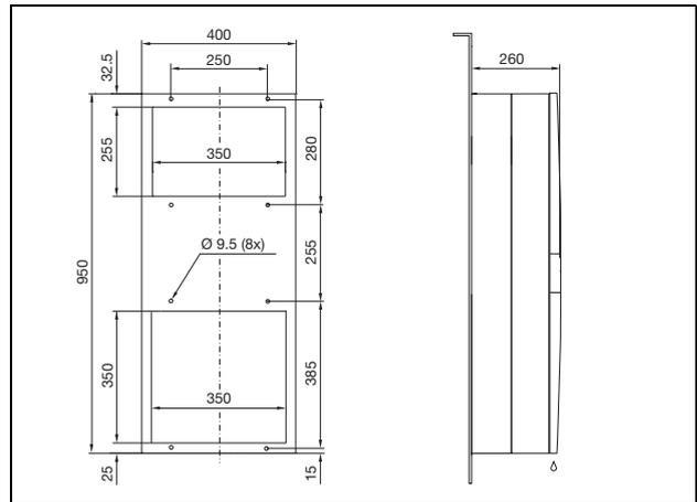
Imagen 95: 3304.xxx, 3305.xxx montaje exterior (excepto equipos NEMA 4X)
