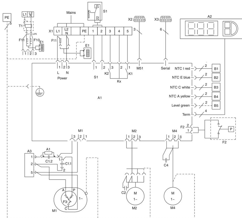
Imagen 117: Esquema de conexiones electrónicas nº 7
