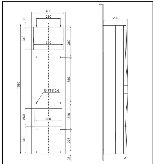
Imagen 96: 3328.xxx, 3329.xxx montaje exterior (excepto equipos NEMA 4X)
