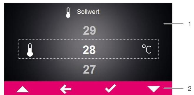
Abb. 19: Bildschirm zum Ändern eines Parameterwerts
