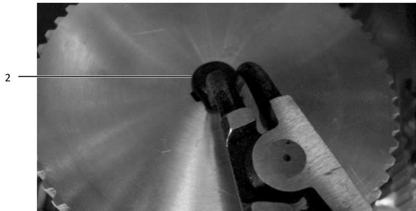
Abb. 10: Sicherungsring entfernen
