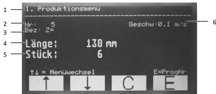
Abb. 4: Display mit Produktionsmenü
