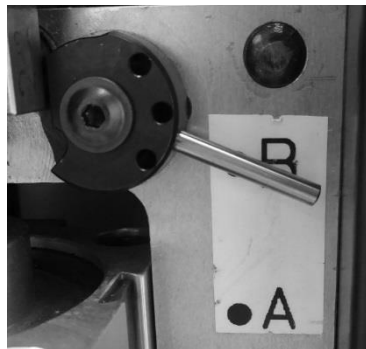
Abb. 11: Einstellung Litzenfixiereinheit (eingestellt: B)
