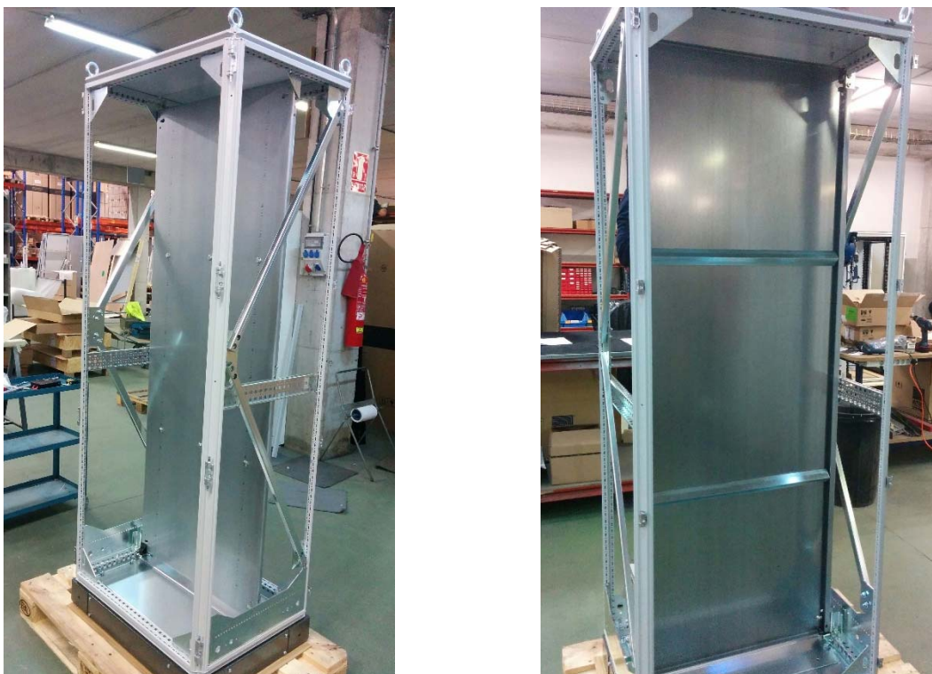
Figura 5: Armario Rittal con zócalo y kit antisísmico
