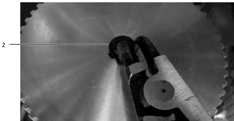
Fig. 10: Rimozione dell'anello di blocco
