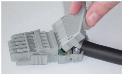
Рис. 65: Закрывание корпуса для разгрузки от натяжения
