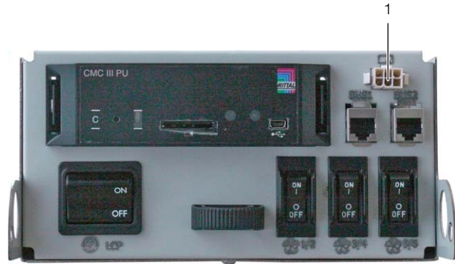
Рис. 48: Точка подключения на электронном модуле
