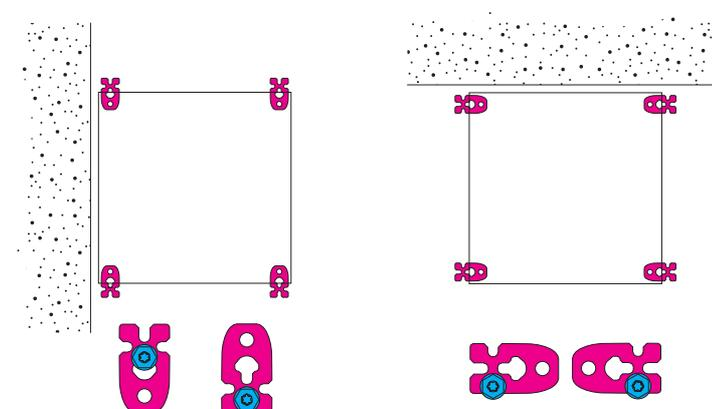
Fixation à l'aide de vis perceuses auto-taraudeuses
