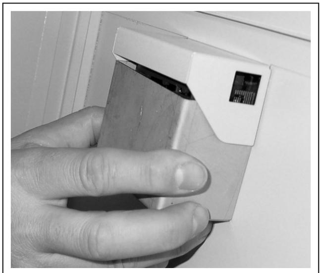
Abb. 15: Abdeckung aufschieben
