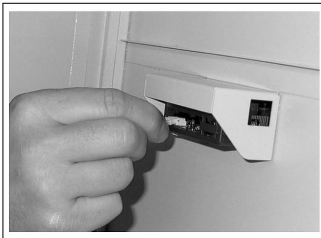
Fig. 13 : brancher le câble de raccordement de l'afficheur
