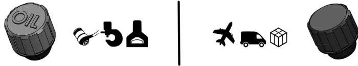
Fig. 3: Sostituzione del tappo di chiusura o della vite di sfiatione (figura a titolo esemplificativo)
