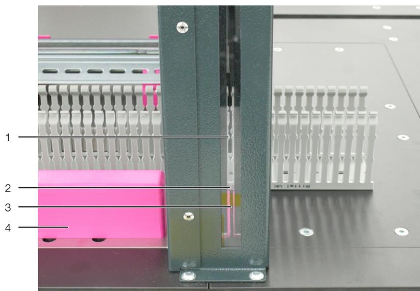
Fig. 13: Allineamento di una canalina
