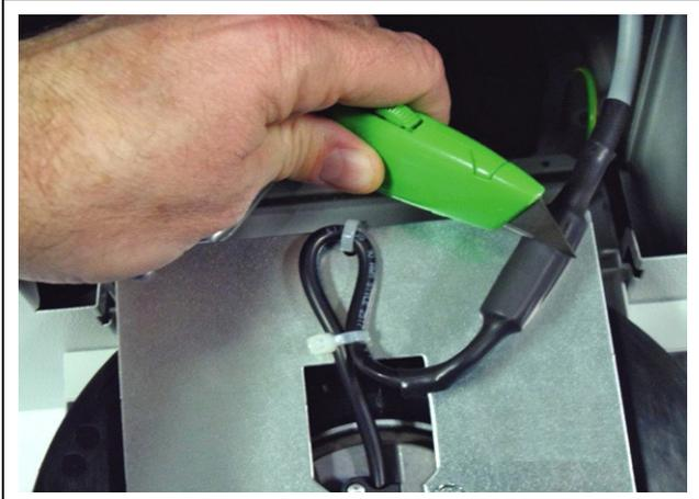
Fig. 27: Schrumpfschlauch, der den Steckverbinder ummantelt, abschneiden
