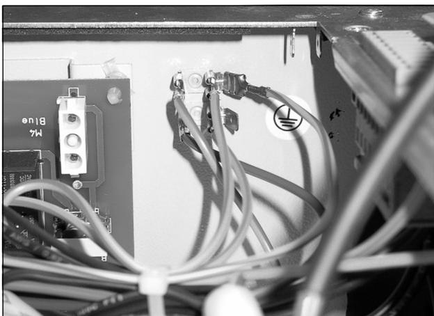
Fig. 23 : Ôter le câble de mise à la masse
