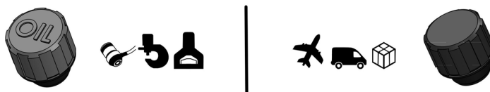
Εικ. 3: Αντικατάσταση της βιδωτής τάπας ή αντίστοιχα της βίδας αερισμού (ενδεικτική απεικόνιση)
