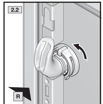
**i** Auch mit Tragarmanschluss nach unten montierbar
