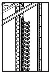
**3. Montage Kabelfinger 6 HE für 19"-Profilschienen dynamic**
